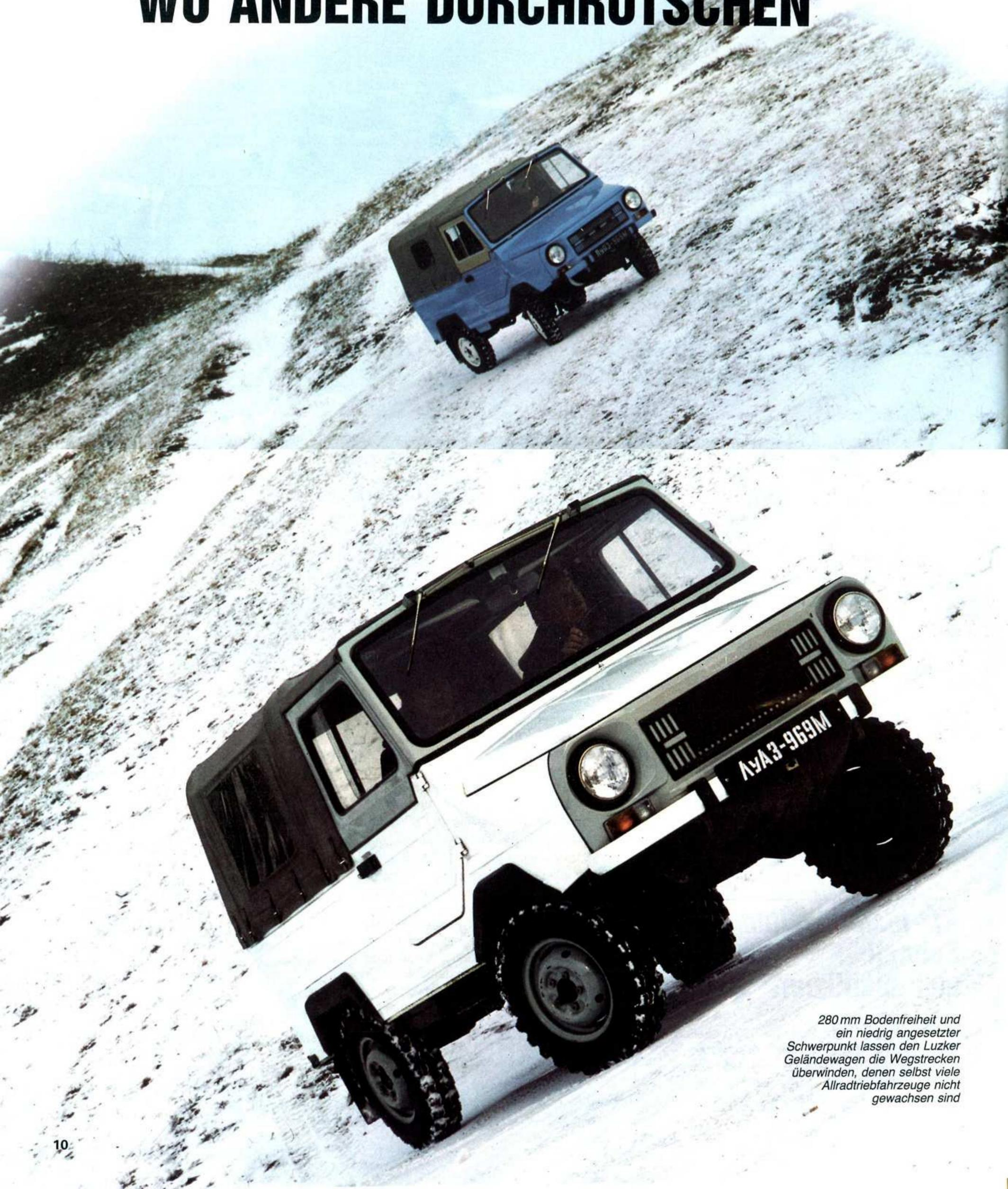
280 mm Bodenfreiheit und ein niedrig angesetzter Schwerpunkt lassen den Luzker Geländewagen die Wegstrecken überwinden, denen selbst viele Allradtriebfahrzeuge nicht gewachsen sind
